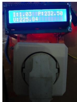
Gambar 4. Hasil Pembacaan Sensor Pada Beban 80 Watt
