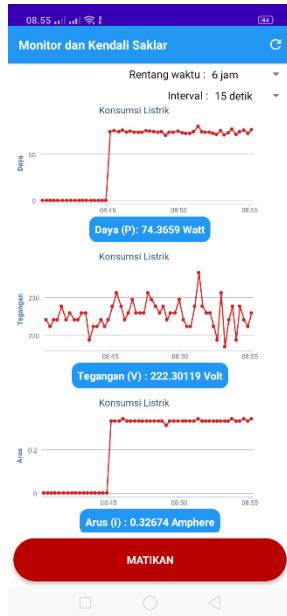
Gambar 6. Antarmuka Monitoring dan Kendali Pada Beban 80 Watt
