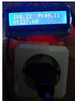
Gambar 4. Hasil Pembacaan Sensor Pada Beban 80 Watt
