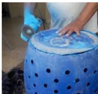
Gambar 1. Proses pemotongan dan melubangi sisi tong sampah
