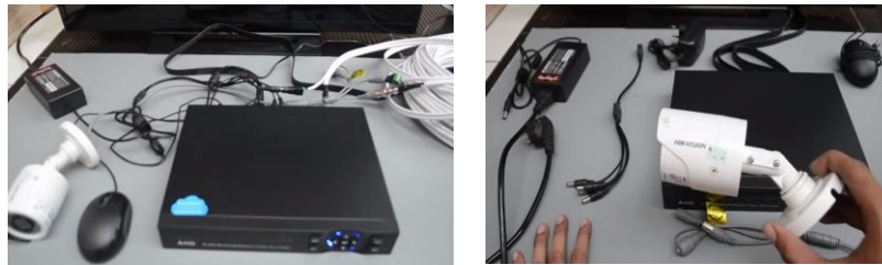
Gambar 1. Perangkat peripheral Instalasi CCTV
